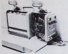
Noodverlicht-Set prim: 220 volt, en werkt op ACCU als het lichtnet uitvalt, met 2 lampen Halogeen 6 volt 50 watt en kan 1 uur branden. De accu is nikkel- ijzer, het geheel met laadinrichting kost f 395,-
